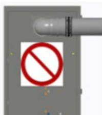
3. NO instale ningún codo directamente en el codo instalado de fábrica.
